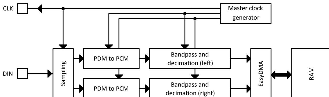
Figure 70: PDM module
