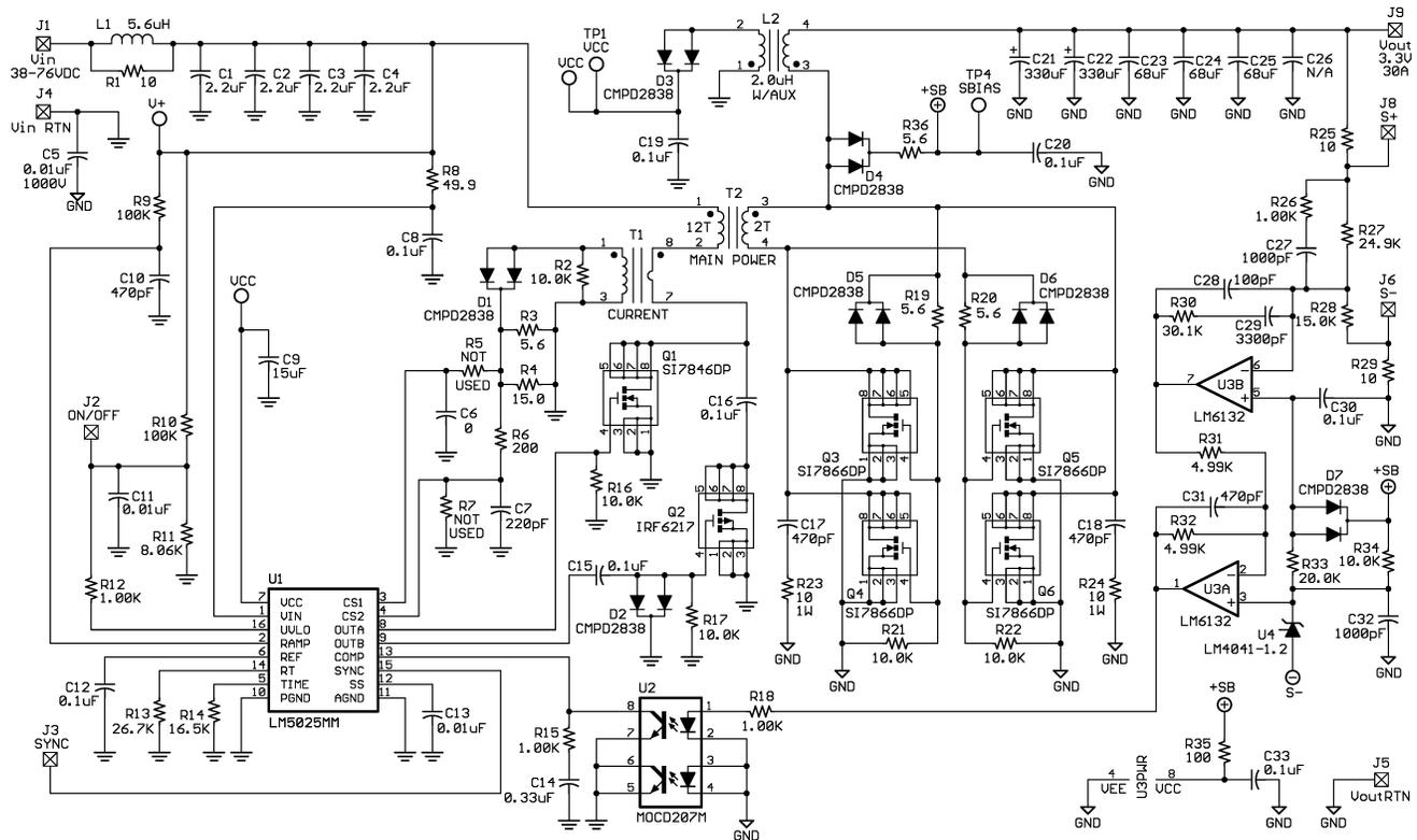
**Figure 21. Application Circuit**
