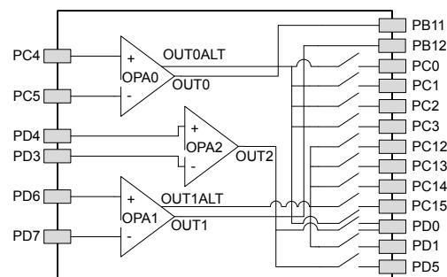
Figure 5.32. Opamp Pinout
