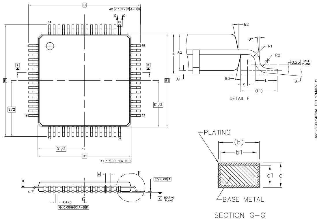
Figure 9.1. TQFP64
