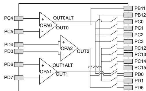
Figure 5.28. Opamp Pinout
