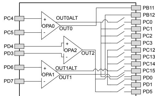
Figure 5.16. Opamp Pinout
