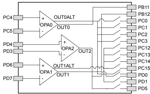
Figure 5.8. Opamp Pinout
