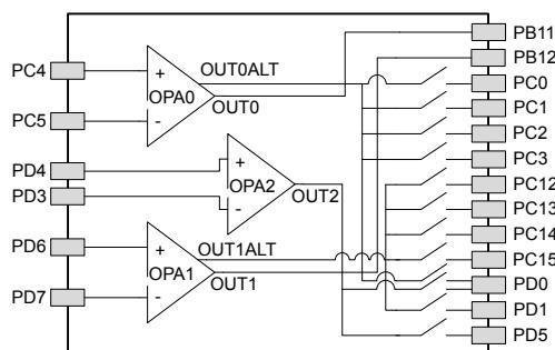
Figure 5.30. Opamp Pinout
