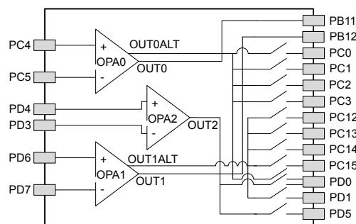
**Figure 5.12. Opamp Pinout**
