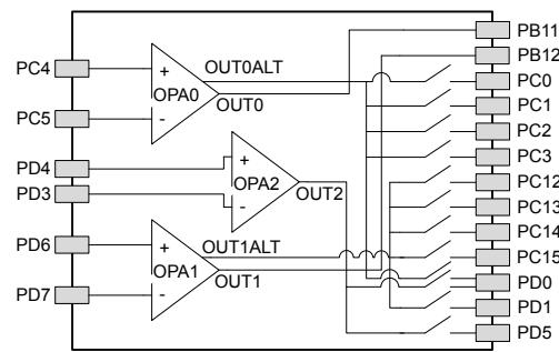
**Figure 5.10. Opamp Pinout**
