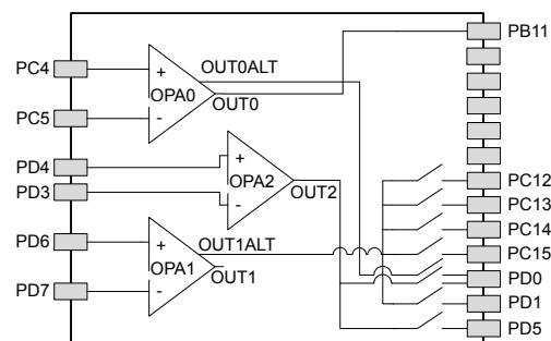
Figure 5.24. Opamp Pinout
