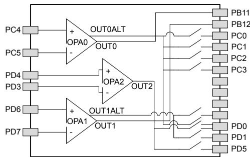
Figure 5.18. Opamp Pinout
