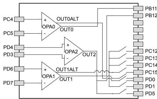
**Figure 5.34. Opamp Pinout**
