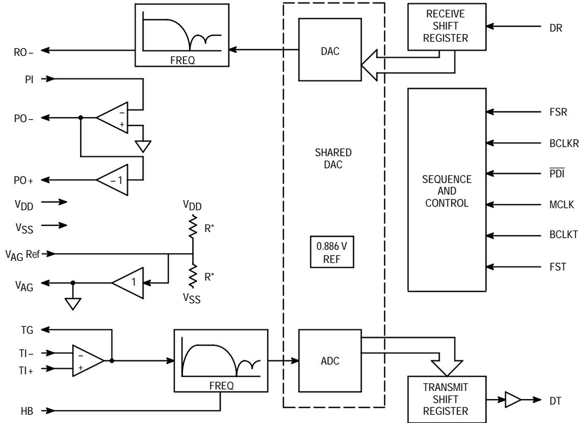
**Figure 1. MC145483 13-Bit Linear PCM Codec-Filter Block Diagram**
